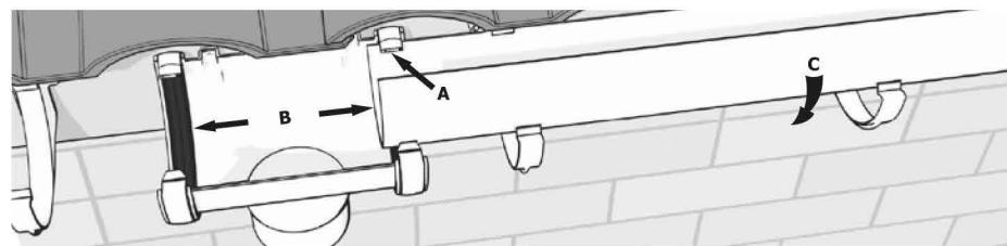
**5** Смонтируйте хомуты трубы на расстоянии не более 1000 мм друг от друга, при этом расстояние от края соединительных элементов трубы до ближайшего хомута не должно превышать 500 мм. Для крепления хомутов к стене используйте саморез либо шуруп-шпильку М6 достаточной длины.
