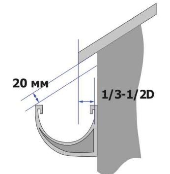
В случае монтажа желоба под уклоном отступ в 20 мм отсчитывается от верхней точки верхнего внешнего края желоба.
